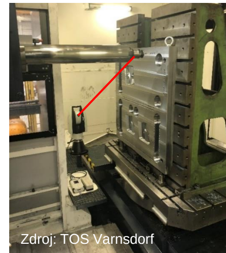
Přídavné odměřování laser trackerem
