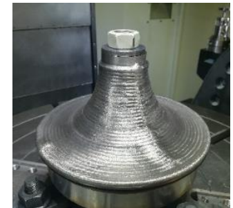
Navařená základová vrstva na soustružený polotovár
